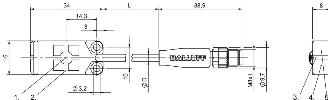
1) 感應面, 2) 外殼, 3) 蓋子, 4) 工作電壓顯示, 綠色, 5) 功能顯示, 黃色
