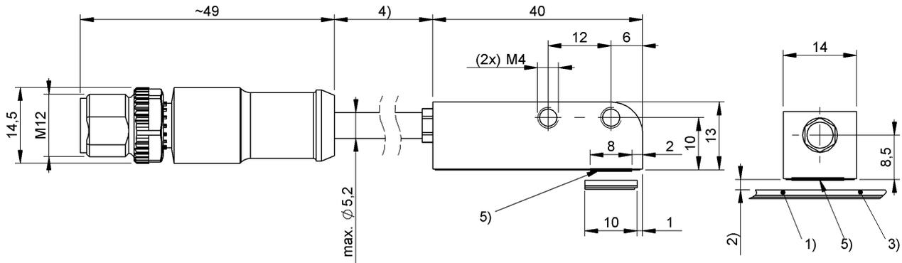
1) 不包含在供貨範圍內, 2) 至測量頭的距離, 3) 測量頭, 4) 電纜長度, 5) 有效測量面
