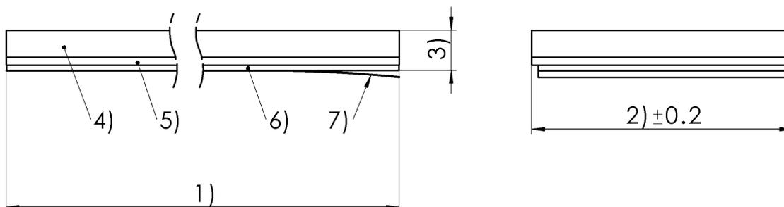
1) 額定長度 / 訂購長度, 2) 寬度, 3) 測量頭高度, 4) 磁層, 5) 基帶, 6) 黏接層, 7) 可撕下的保護膜
