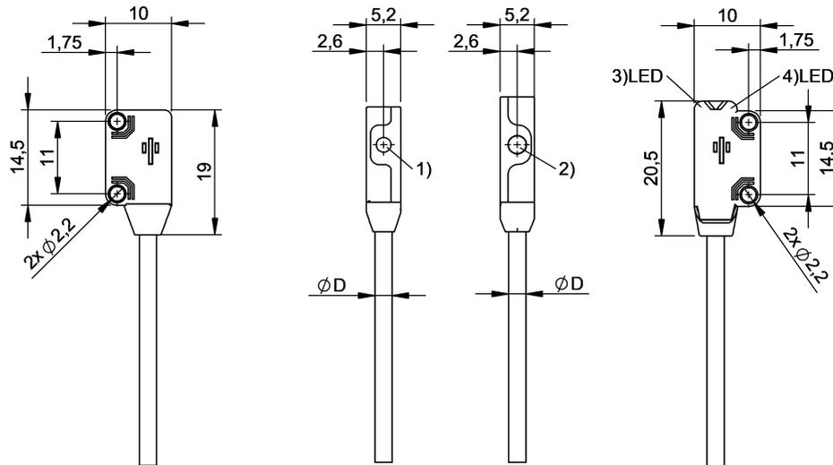
1) 發射器, 2) 接收器, 3) LED (狀態), 4) LED (電源)
