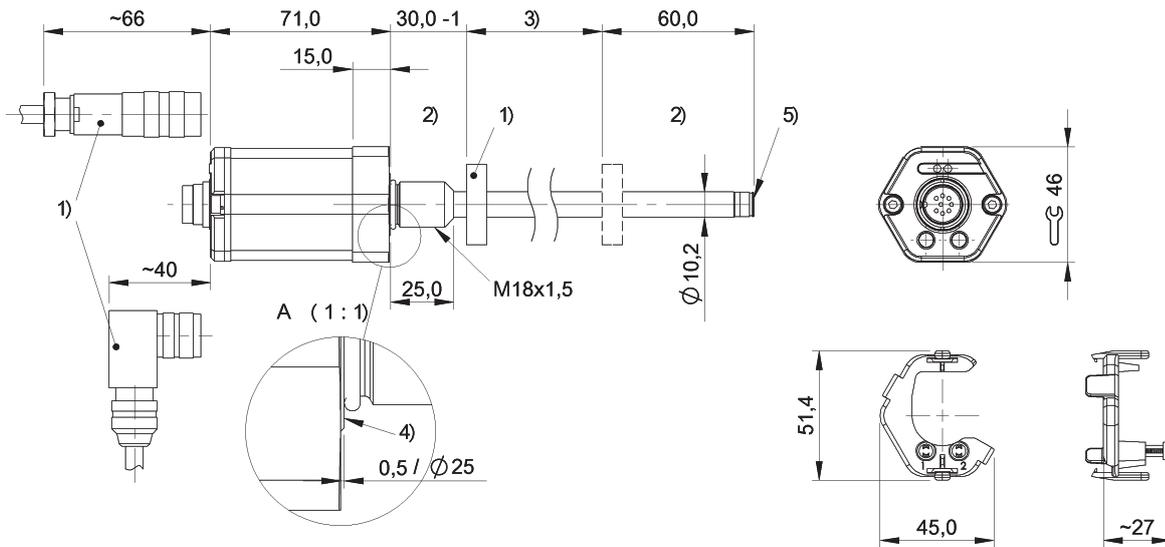
1) 不包含在供货范围内 2) 不能使用的区域 3) 额定长度 = 测量长度 4) 接触面 5) 内螺纹M4x4/6, 深
