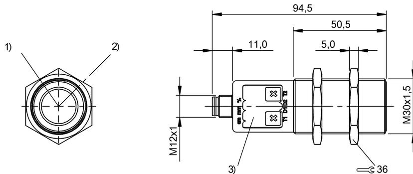
1) 軸, 超聲波轉換器, 2) 退出方向, 90° 插頭, 3) 顯示和操作區
